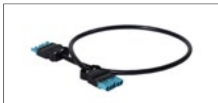
Forlængerledning Wieland, 5-polet. 1-faset + lysregulering. 5x1,5 mm 2 . L= 1,0 m, 2,0 m, 2,5 m, 3,0 m.
