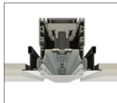
Notor Opal Dropped montert i E-kant liggende i himlingen.
