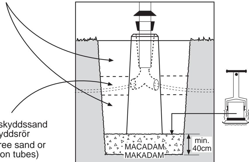
**S** Dränera alltid och se till att det fungerar genom att fylla med vatten och kontrollera att det runnit bort inom 15 min.
