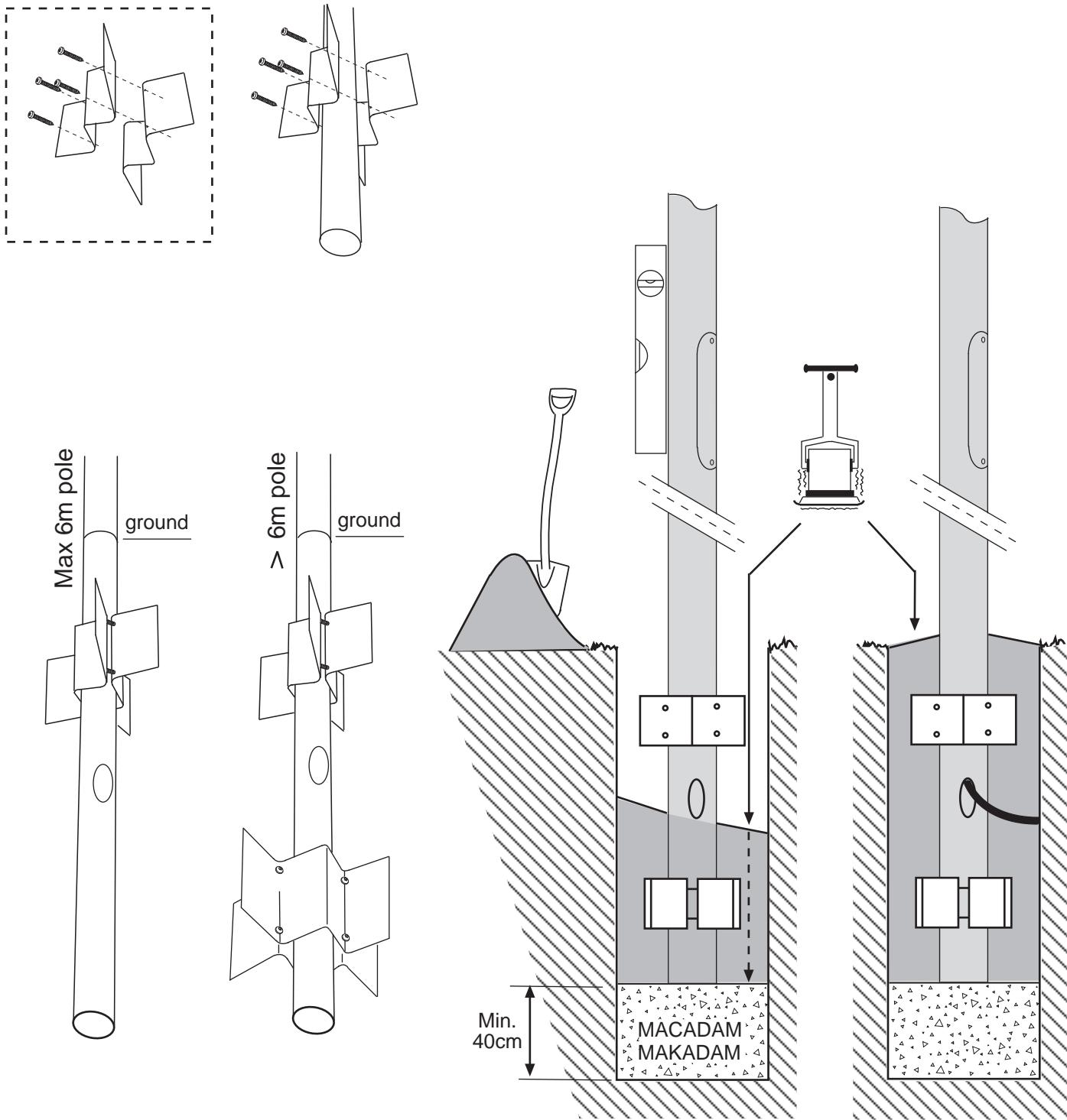
**(S)** Dränera alltid och se till att det fungerar genom att fylla med vatten och kontrollera att det runnit bort inom 15 min.
