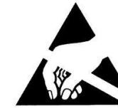
Das Produkt enthält Elektronik die empfindlich für elektrostatische Entladungen (ESD) sowie mechanischer Belastung sein kann. Um Schäden zu vermeiden, sollten offene Platinen sowie LED-Module nie direkt mit der Hand oder mit einem Werkzeug berührt werden.
