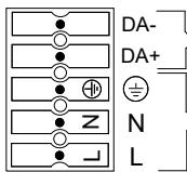
**S** Grundläggande isolering mellan nät och styr ledning.
