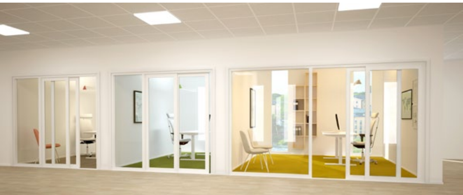
e-Sense Tune mahdollistaa eri värielämpötilojen käytön eri huoneissa. Ensimmäinen huone vasemmalla 4000 K, toinen huone 6500 K ja kolmas huone 3000 K.
