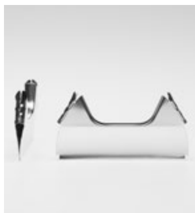
Uuden sukupolven Beta Opti on kehitetty Fagerhultin tehokkaan, pienluminanssihäikäisysuojissa käytettävän r5-optiikan pohjalta. Poikittaislamellit toimivat yhteistyössä tehokkaiden sivuheijastimien kanssa. Tekniikkaa täydentää ainutlaatuinen kalvo, joka viimeistelee valonsuuntauksen tarkkuuden.
